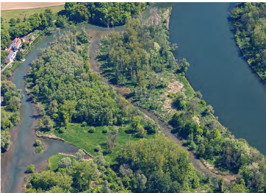
Abb. 5: An der bayerischen Donau wird durch die Entfernung der Uferregulierung und die Wiederanbindung eines Seitenarmes eine ehemalige Insel bei der Ussel-Mündung neu geschaffen. Nach Umsetzung der Revitalisierung wird sie unter strengen Schutz gestellt werden. (Foto: DANUBE PARKS/Auenzentrum Neuburg a.d. Donau/Ingo Bäuerlein, Fa. FrankenAir)
